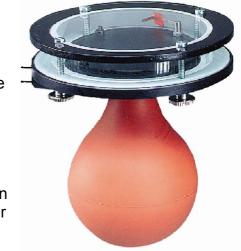
Die Übersättigung der umgebenden Luft mit Wasserdampf wird bei der Wilsonkammer durch plötzliche Entspannung und dadurch bewirkte Abkühlung des Füllgases herbeigeführt. Die Entspannung muss gleichmäßig und wirbelfrei erfolgen, um ein Verwehen der Spuren zu vermeiden.
