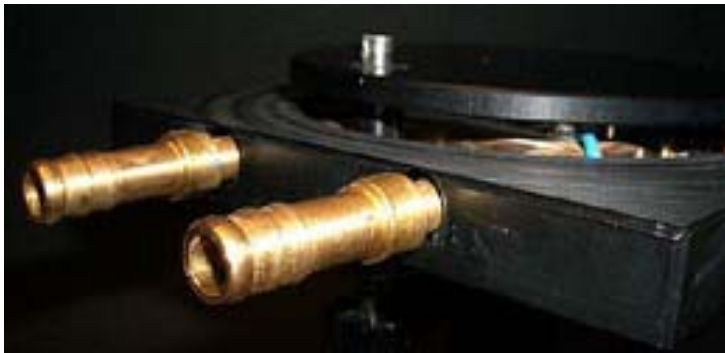
Abb. 7 Anschlüsse für den Kühlwasserkreislauf
