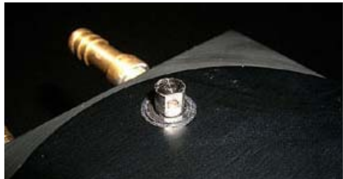
Abb. 3 Einbringen eines Strahlerstiftes in die Nebelkammer
