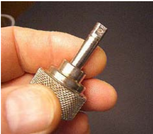
Abb. 3 Einbringen eines Strahlerstiftes in die Nebelkammer
