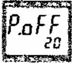
Wird für die Dauer der Abschaltverzögerung keine Taste gedrückt bzw. keine Schnittstellenkommunikation vorgenommen, so schaltet sich das Gerät automatisch ab. In diesem Menü können Sie die gewünschte Verzögerung in Minuten eingeben. Ist P.oFF = oFF, so ist die Abschaltverzögerung deaktiviert, das Gerät schaltet sich nicht automatisch ab.
