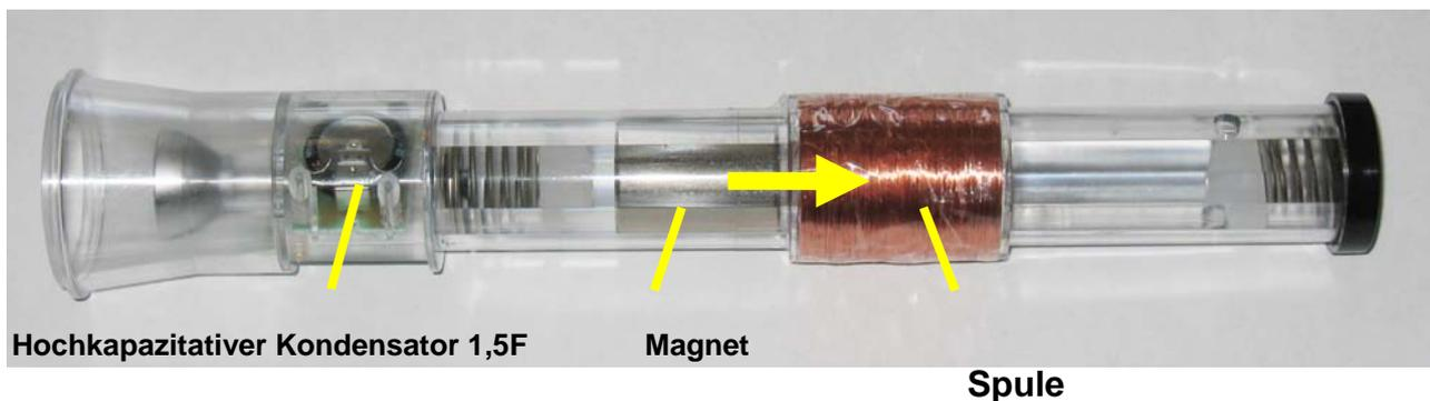
Abb. 1: Aufbau der Lampe
