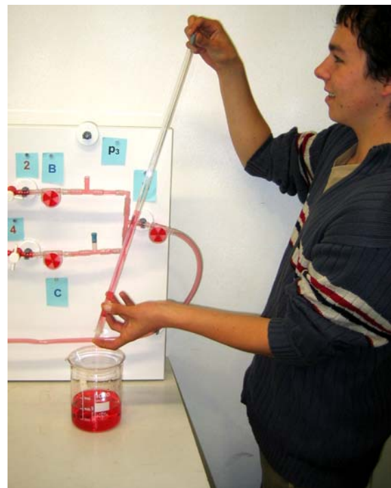
Abb. 8: Wasser wurde angesaugt und dann das Rohr oben verschlossen.
