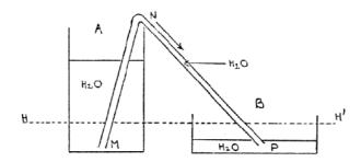
Die beiden Oberflächen bilden kein einheitliches Niveau. Das Glasrohr MNP wird vorher mit Wasser gefüllt. Wir beobachten, dass ein Gleichgewicht hergestellt wird und das Wasser sich auf der gleichen horizontalen Ebene H H' stabilisiert. Das Rohr MNP stellt einen Siphon dar.
