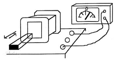
Der induzierte Strom wird durch die Spule Bs gebildet - hier z.B. verbunden mit dem Galvanometer. Der Induktionskreis ist ein Magnet.
