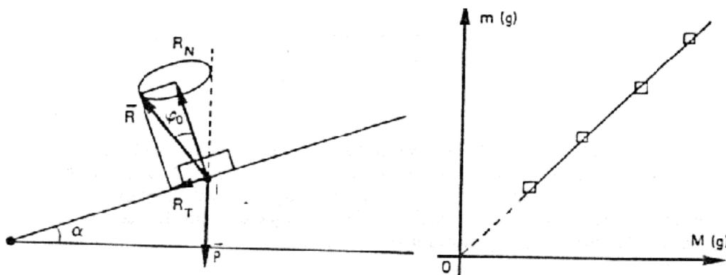
2) Man zeichne für verschiedene Gewichte  $M$  jeweils den Wert  $F$  auf, der vom Kraftmesser angezeigt wird. (wobei  $F$  die Kraft ist, die vom Kraftmesser abgelesen wird, wenn sich der Festkörper in Bewegung setzt).  $M$  ist die Masse des Festkörpers + die Masse der Zusatzgewichte.
