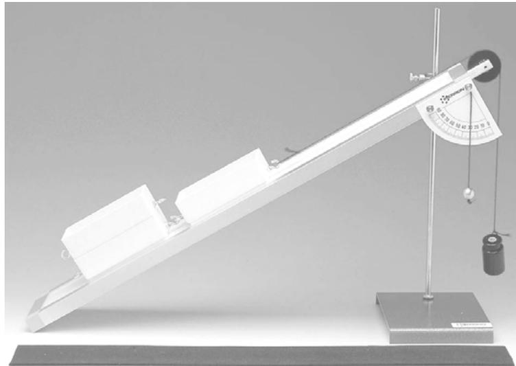
Die Untersuchung der Reibung erfolgt anhand einer schiefen Ebene, deren Oberfläche auswechselbar ist. Drei Oberflächen stehen zur Verfügung: Metall, Kunststoff und Schaumstoff.
