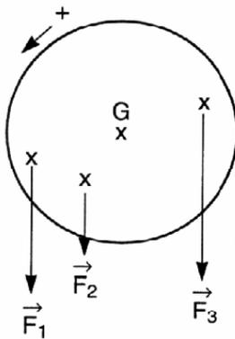
Ich hänge nun eine dritte Masse, z.B. 20 g an einen Punkt der Scheibe. Die anderen beiden Massen bleiben in Position. Die Massen  $m_1, m_2, m_3$  üben die Kräfte  $\vec{F}_1, \vec{F}_2, \vec{F}_3$  aus und ich rechne  $M_G(\vec{F}_1), M_G(\vec{F}_2), M_G(\vec{F}_3)$ .
