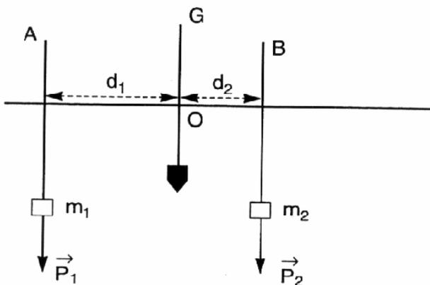
1. Ich realisiere den Versuchsaufbau nach Fig. 1, indem ich für  $m_1 = 50 \text{ g}$  und  $m_2 = 100 \text{ g}$  nehme.
