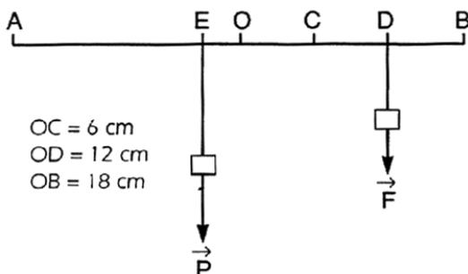
10. Ich realisiere das Gleichgewicht des Stabs, indem ich Kräfte  $\vec{F}_1$ ,  $\vec{F}_2$ ,  $\vec{F}_3$ , sukzessiv auf C, D und B einwirken lasse, Kräfte, die ich mit Hilfe des Dynamometers messe.
