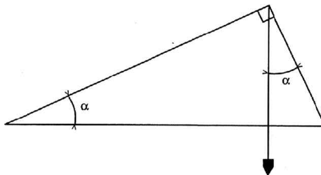
2. Ich neige die Schiefe Ebene nach einem beliebigen Winkel (s. Fig. 1) und vergleiche dann die Intensität der Spannung des Fadens  $\vec{T}$ , gemessen mit dem Kraftmesser – mit der Größe des Gewichtes  $\vec{P}$ .
