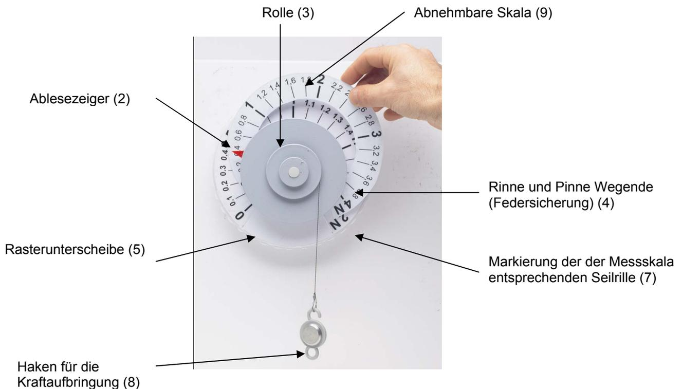
Der Kraftmesser ist dank eines Magneten leicht an einer Metalltafel anzubringen.
