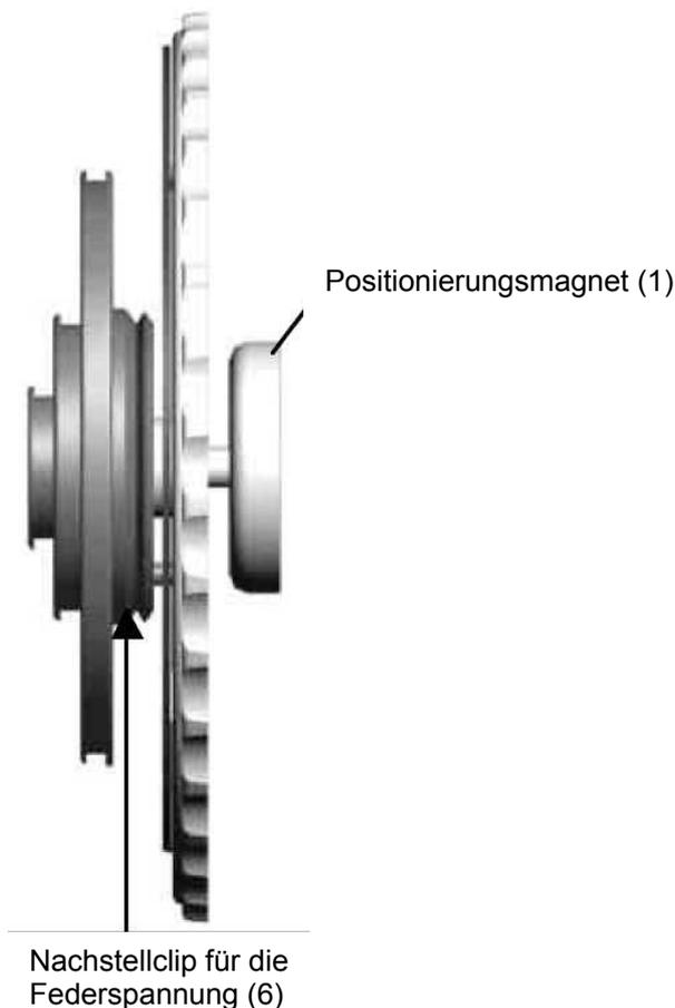
**Wartung und Einstellung der Genauigkeit der Federspannung:** Nach längerer Benutzung kann die Feder sich ausdehnen. Testen Sie mit Hilfe eines Ihnen bekannten Gewichts die maximale Kapazität Ihres Kraftmessers und passen Sie dann Ihre Einstellung an, indem Sie den stark eingespannten Clip (6) nach rechts oder links verstellen.
