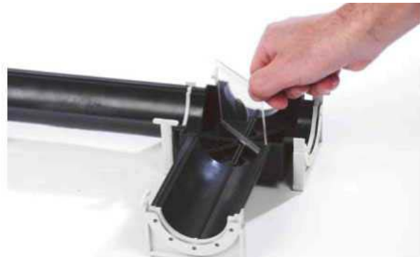
Einsetzen des Spiegels \varnothing 20 mm in 45° Position der optischen Achse (verwenden Sie die Rillen am Boden des Teleskopteils)
