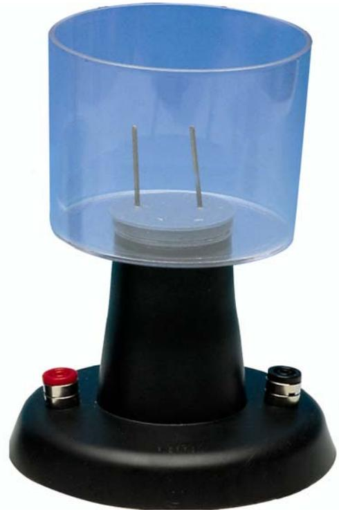
Da der Kelch breit und konisch ausgeführt ist, können Reagenzgläser problemlos auf die Elektroden aufgesetzt werden. Der breite Sockel gewährleistet einen guten stabilen Halt. Das obere Ende des Sockels weist eine Öffnung mit einem Durchmesser von 40 mm auf, damit die Elektroden, die in Gummistopfen eingebaut sind, aufgesetzt und ausgetauscht werden können.
