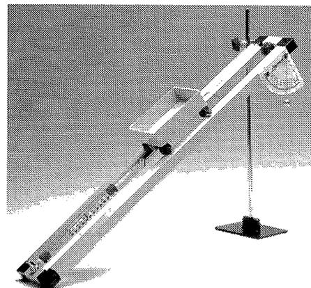
Man kann die Neigung verändern, indem man die Befestigungsschraube am Stab lockert und dann die Höhe der Schiene variiert. Auf den Rollkörper können verschiedene Massen gelegt werden.
