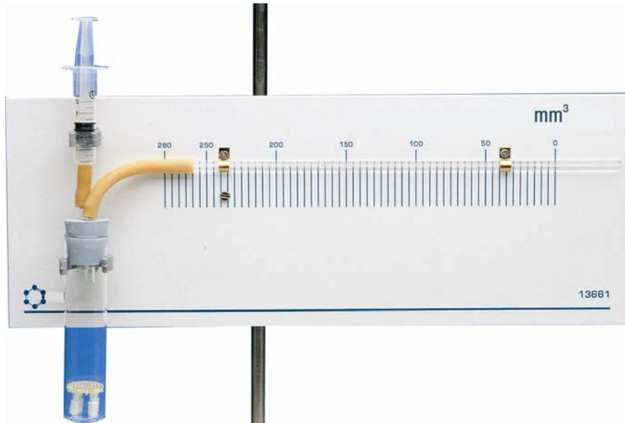
Dieser einfache und logisch konzipierte Apparat, ermöglicht quantitative Messungen von Sauerstoff, welcher durch Lebewesen oder Pflanzen verbraucht wurde. Dank einer Kapillarvorrichtung, welche in horizontaler Position angebracht wurde, können auch sehr kleine Absorptionsvolumina (0,4 ml) gemessen werden.
