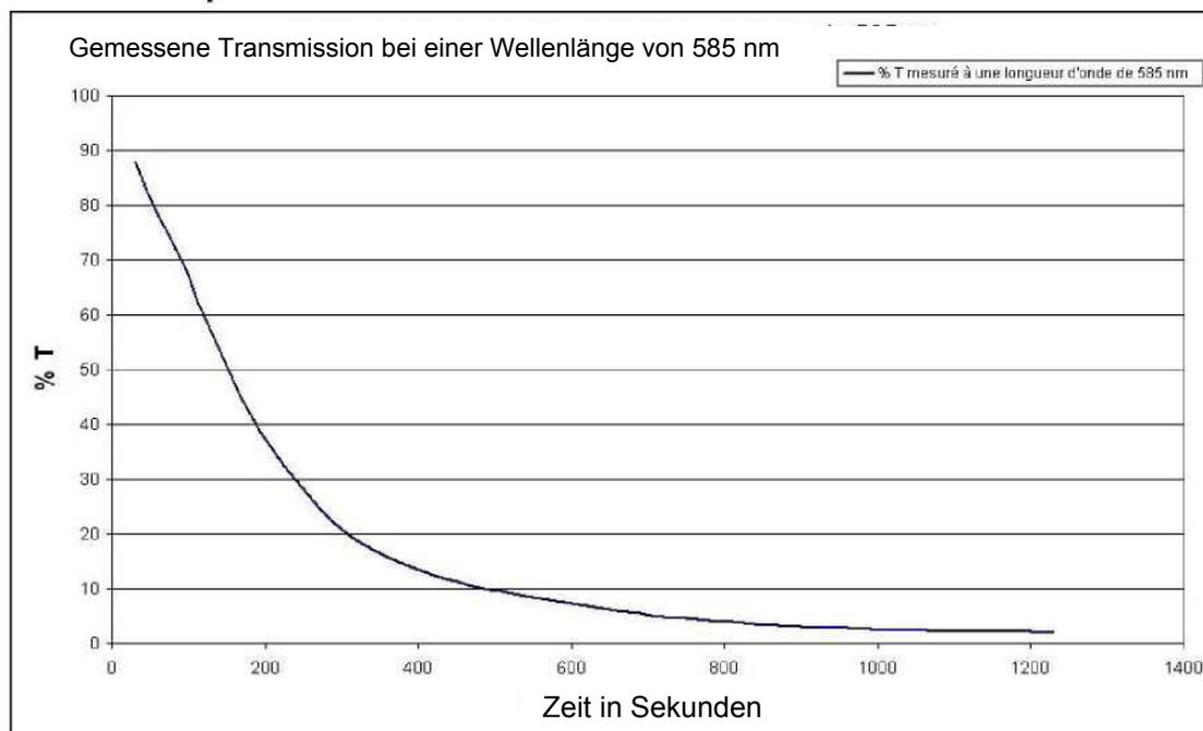
Reaktionsgeschwindigkeit der enzymatischen Oxidation von Guaiacol durch das aus Radieschen gewonnene Enzym Peroxidase (für eine Verdünnung des Filtrats von 1:5 und eine Versuchsdauer von 21 Minuten)
