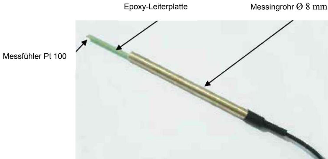
Bei dem mit dem Mesura-Thermometer mitgelieferte Temperaturmessfühler handelt es sich um eine Sonde vom Typ Pt 100, deren Messbereich zwischen  $-40 / +110$  °C liegt und die auf einer Platine montiert ist. Dieser wiederum ist innerhalb eines Messingrohrs mit einem Außendurchmesser von 8 mm in Vergussmasse (Araldid) eingegossen.
