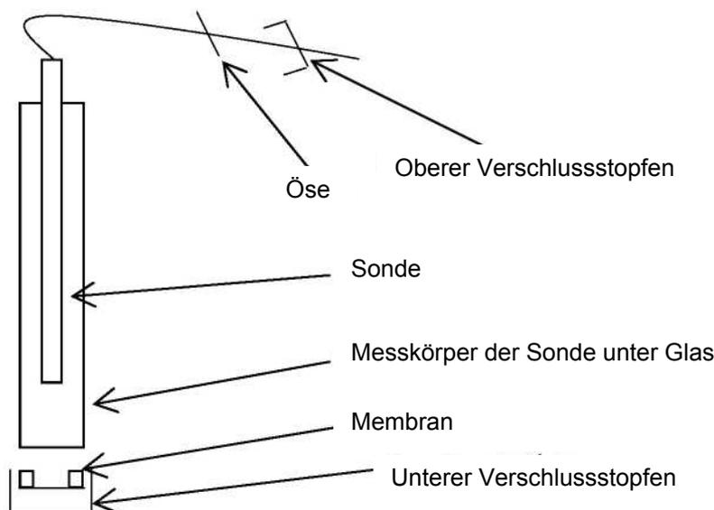
1. Führen Sie die Teflonmembran ganz unten am Messkörper der Sonde ein.
