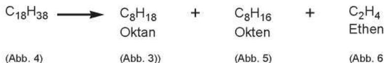
Beachten Sie, daß bei der Anfertigung des Okten-Modells die beiden Kohlenstoffatome am Ende der Kette mit einem Paar weißer *biegsamer* Halme verbunden werden. Diese Bindung ist reaktionsfähig, und wird "Doppelbindung" genannt (siehe auch Karte 6). Dieselbe Bindungsart verbindet die Kohlenstoffatome in Ethen (Abbildung 6).
