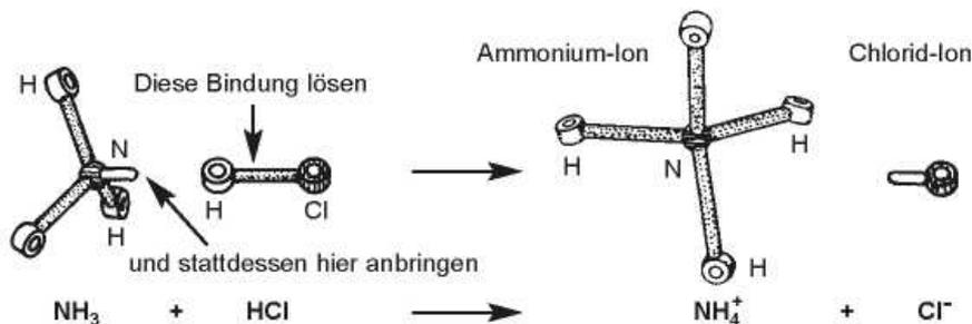
Fertigen Sie Modelle von Ammoniak und Chlorwasserstoff an: veranschaulichen Sie die obige Reaktion, indem Sie ein Proton (Wasserstoff-Atomkern) übertragen.
