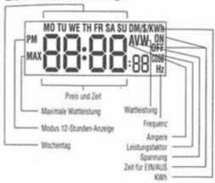
Das Energiemessgerät PM 230 ist ein Überwachungs- und Prüfgerät mit dem der Stromverbrauch eines angeschlossenen Gerätes festgestellt und die Kosten für den Verbrauch ermittelt werden können.
