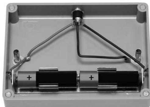
Alternativ kann ein Stecker-Netzgerät (Bestellnummer 68534) mit 3 V (DC) über die seitlich eingebaute Niedervolt-Steckbuchse angeschlossen werden. Die eingesetzten Batterien werden dabei abgeschaltet.
