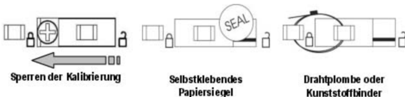
Abbildung 4-1. Sperren und Versiegeln des Kalibrierungssperrschalters
