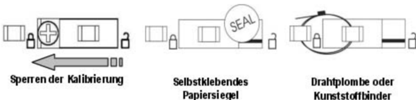
Abbildung 4-1. Sperren und Versiegeln des Kalibrierungssperrschalters
