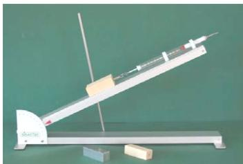
Auf einen Körper mit dem Gewicht  $F_G$  wirkt parallel zu einer schiefen Ebene die Hangabtriebskraft  $F_H$ .  $F_H = F_G \cdot \sin \alpha$ . Und senkrecht zur schiefen Ebene die Normalkraft  $F_N$ .  $F_N = F_G \cdot \cos \alpha$
