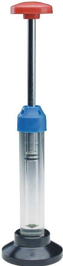
Cet équipement démontre que la température d'une quantité de gaz piégée augmente à mesure que le gaz est comprimé. Si un matériau inflammable est placé au bas du cylindre transparent, il s'enflamme lorsque le piston est enfoncé avec un mouvement rapide. Ce principe est utilisé entre autres dans les moteurs diesel. Le briquet pneumatique est fourni avec des bagues d'étanchéité supplémentaires et une cuve.
